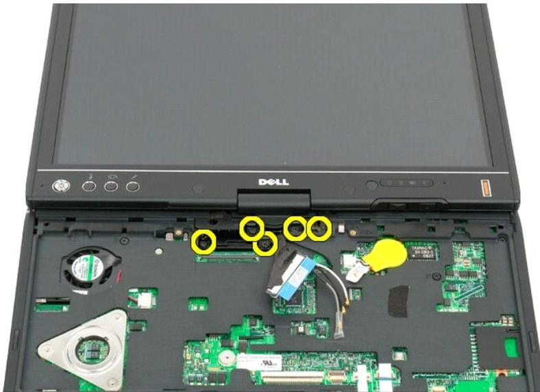
11. Sollevare l'assemblaggio dello schermo per staccarlo dal Tablet PC.
