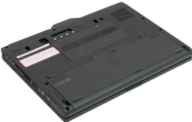
2. Spingere i due ganci sull'alloggiamento della batteria nella parte inferiore del Tablet PC verso l'esterno.
