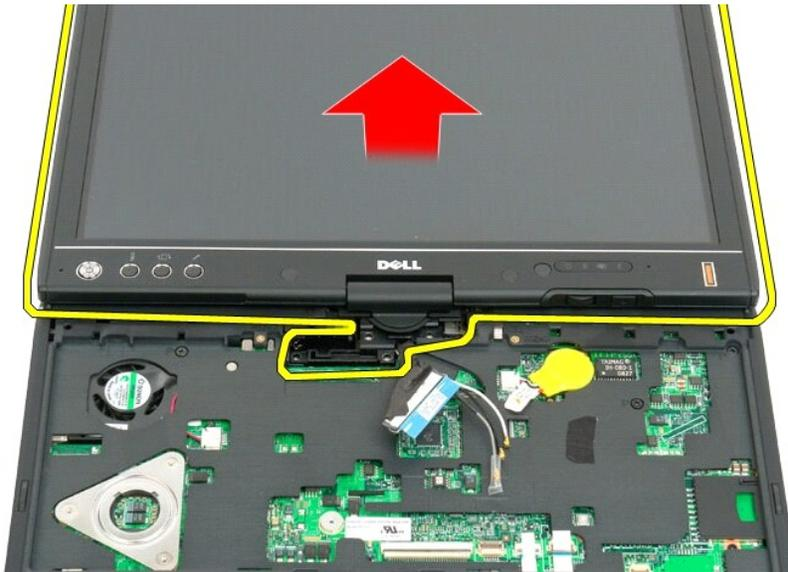
12. Rimuovere l'assemblaggio dello schermo.
