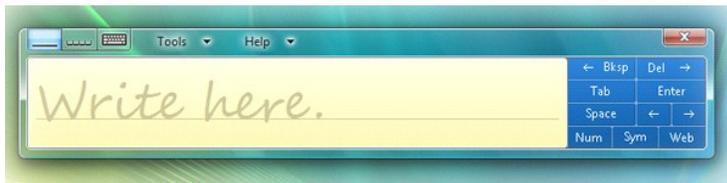
Per inserire il testo, è possibile utilizzare il taccuino di scrittura, il modulo dei caratteri o la tastiera virtuale. Il taccuino di scrittura e il modulo dei caratteri convertono la scrittura manuale in testo digitato. La tastiera virtuale funziona come una normale tastiera, solo che il testo viene inserito toccando i tasti con la penna. Nella seguente tabella sono illustrate le diverse opzioni di utilizzo del Pannello di immissione.
