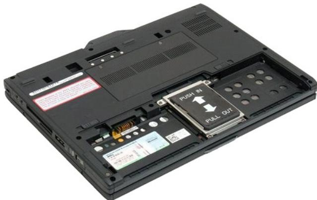
3. Allentare le quattro viti di fissaggio sul supporto del disco rigido.
