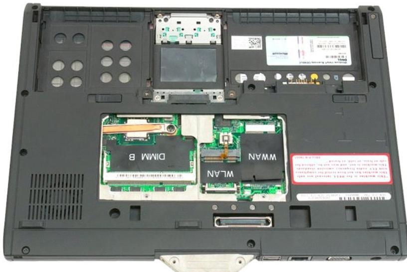
7. Rimuovere le nove viti che fissano la base palmare alla parte inferiore del Tablet PC.
