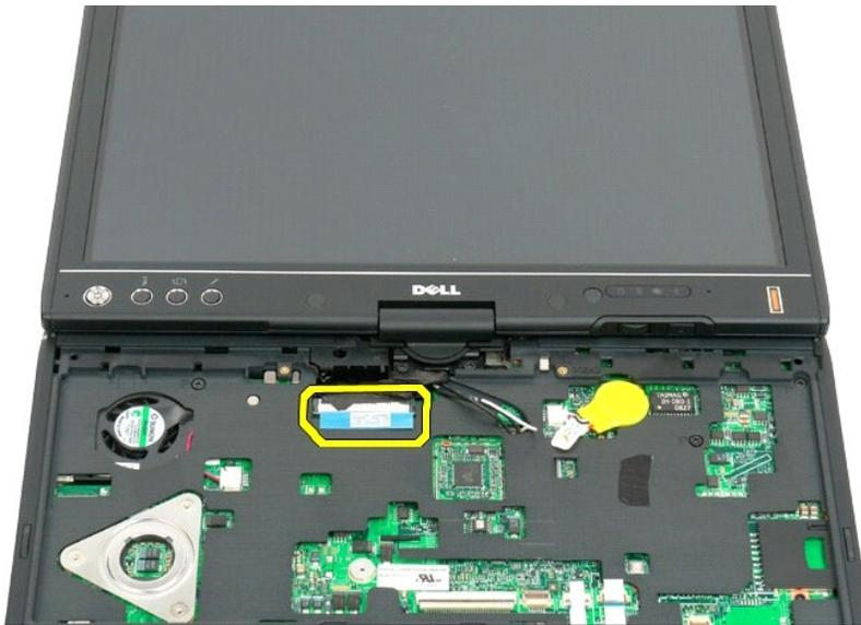
9. Sfilare i cavi dell'antenna dall'interno del Tablet PC.
